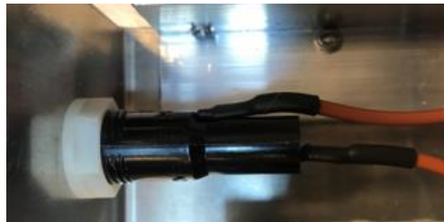
Rafmagnið fer inn í botninum á varhúsinu og út á hliðinni.
