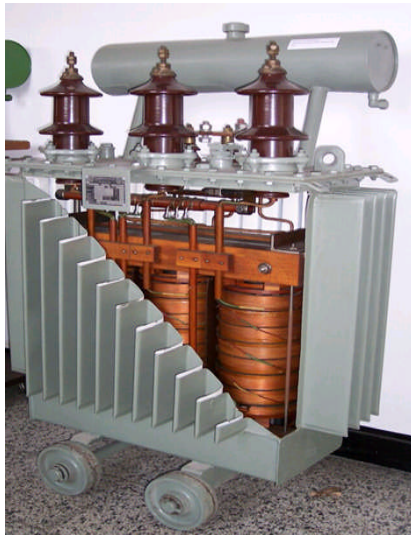
Mynd 9.1. Þrífasa ONAN dreifispennir. Um snið í ytri umlykju spennisins má greina kjarnann og vöfin.
