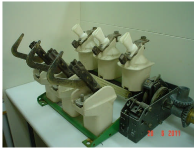
Mynd 8.2 Álagsskilrofi 12 kV frá BBC
