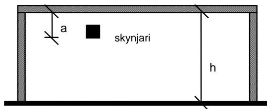
Mynd 7 Mæling lofthæð og á fjarlægð frá lofti að skynjara þegar þak er flatt
